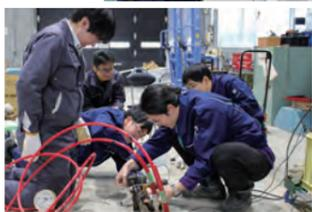
引抜き試験（片引きの付着試験）の様子
