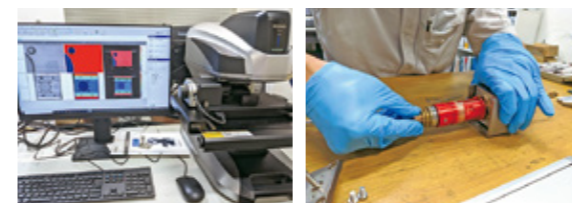
図4 採寸に活用した3D形状測定機
