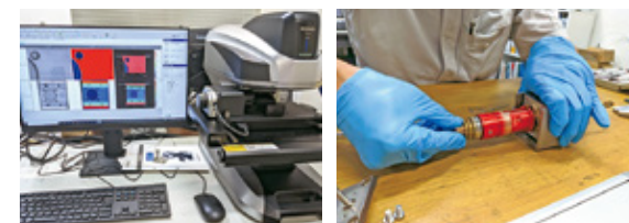
図4 採寸に活用した3D形状測定機
