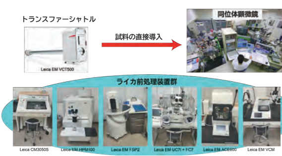
シームレスに接続される同位体顕微鏡とライカ前処理装置群
