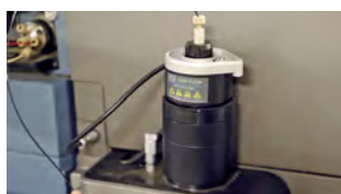
Waters社製 UPLC/MS Mclass 300μmカラム仕様 イオン化プローブ交換作業一式
